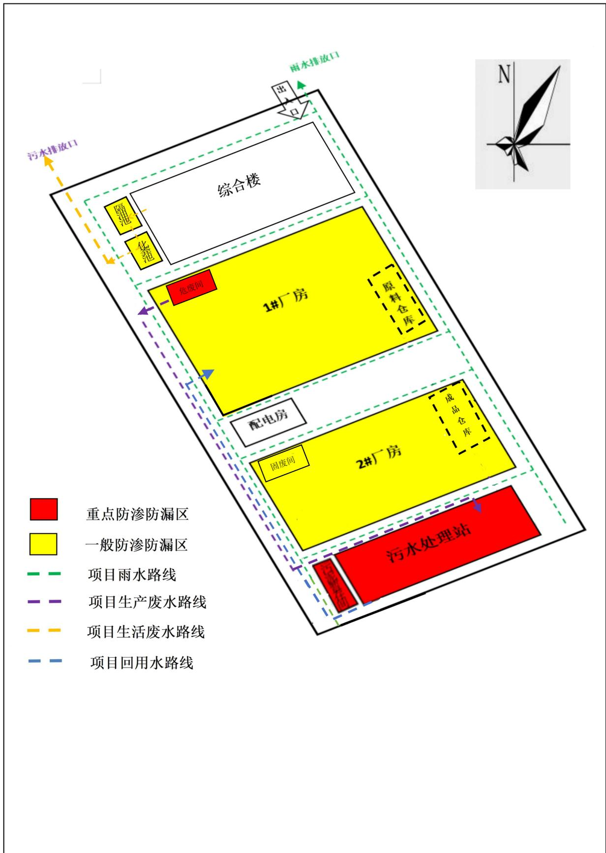
附图3 项目平面布置图及雨污管网图
